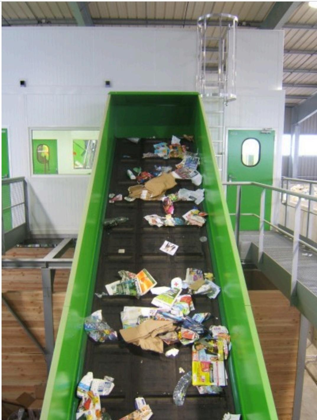
Les déchets arrivent progressivement dans la cabine de pré-tri. Là, 4 agents vont prélever manuellement les erreurs de tri et isoler les gros cartons d'emballages qui ne passent pas par le séparateur mécanique car trop gros. Cette tâche fastidieuse et répétitive est nécessaire tant les erreurs ou malveillances demeurent encore nombreuses.
